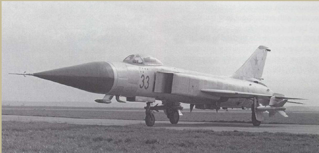
T-58D-3: már az Oryol radarral a korai változatokra jellemző kúpos orrban
