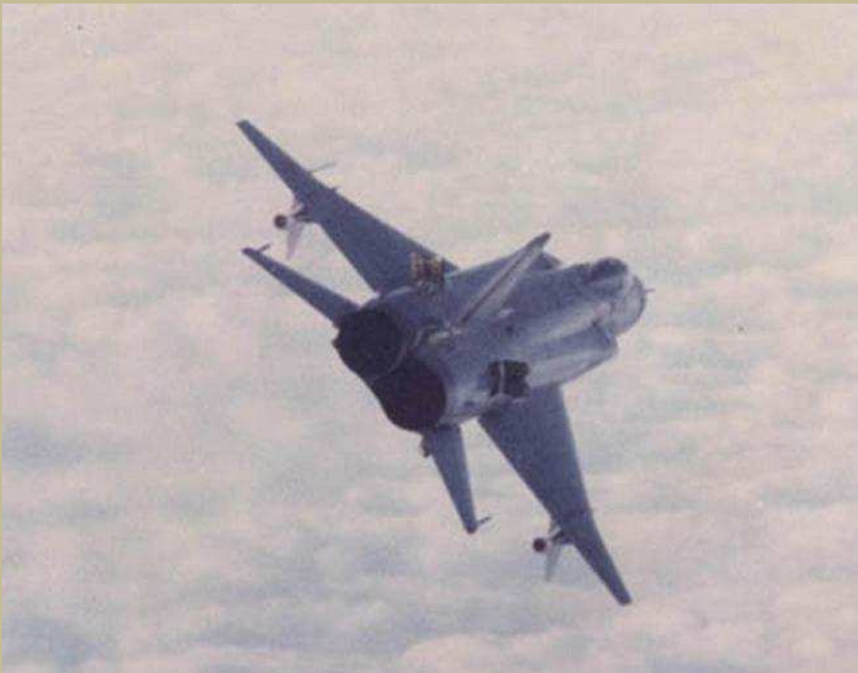
A Flagon módosított két nyílzási szöggel rendelkező szárnya és a törzsféklapok nyitott állapotban
