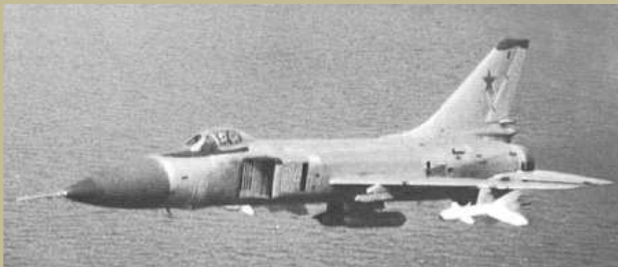
Szu-15TM két UPK konténerrel és R-98MT rakétával
