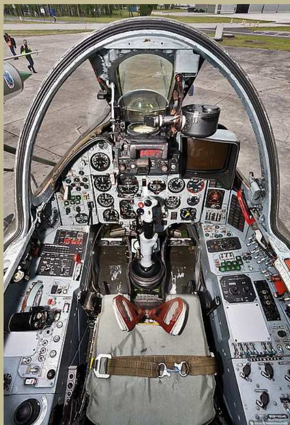
A képeken M4-es változatok belseje látható: baloldalon egy lengyel Fitter TV képernyővel felszerelt pilótafülkéjéről készült kép, jobb oldalon egy korábbi cseh társa látható, amely nem rendelkezett a beépített televíziós kijelzővel
