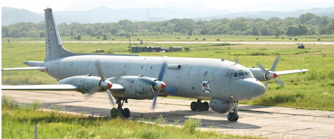
Az Il-38 „May” volt az első szovjet repülőgép amelyet digitális fedélzeti számítógéppel láttak el
