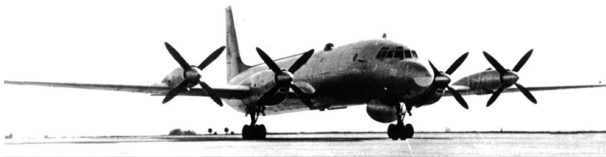
A prototípus kezdetben nem rendelkezett a Berkut-rendszer elemeivel, mégis kialakították a radar és a MAD-szenzor áramvonalazott burkolatát az aerodinamikai tesztek gyorsabb lefolytatása végett
