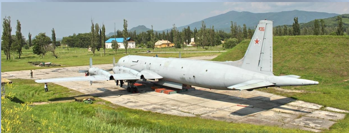
A mágneses anomália detektor (MAD) miatt a törzs 4 méterrel vált hosszabbá
