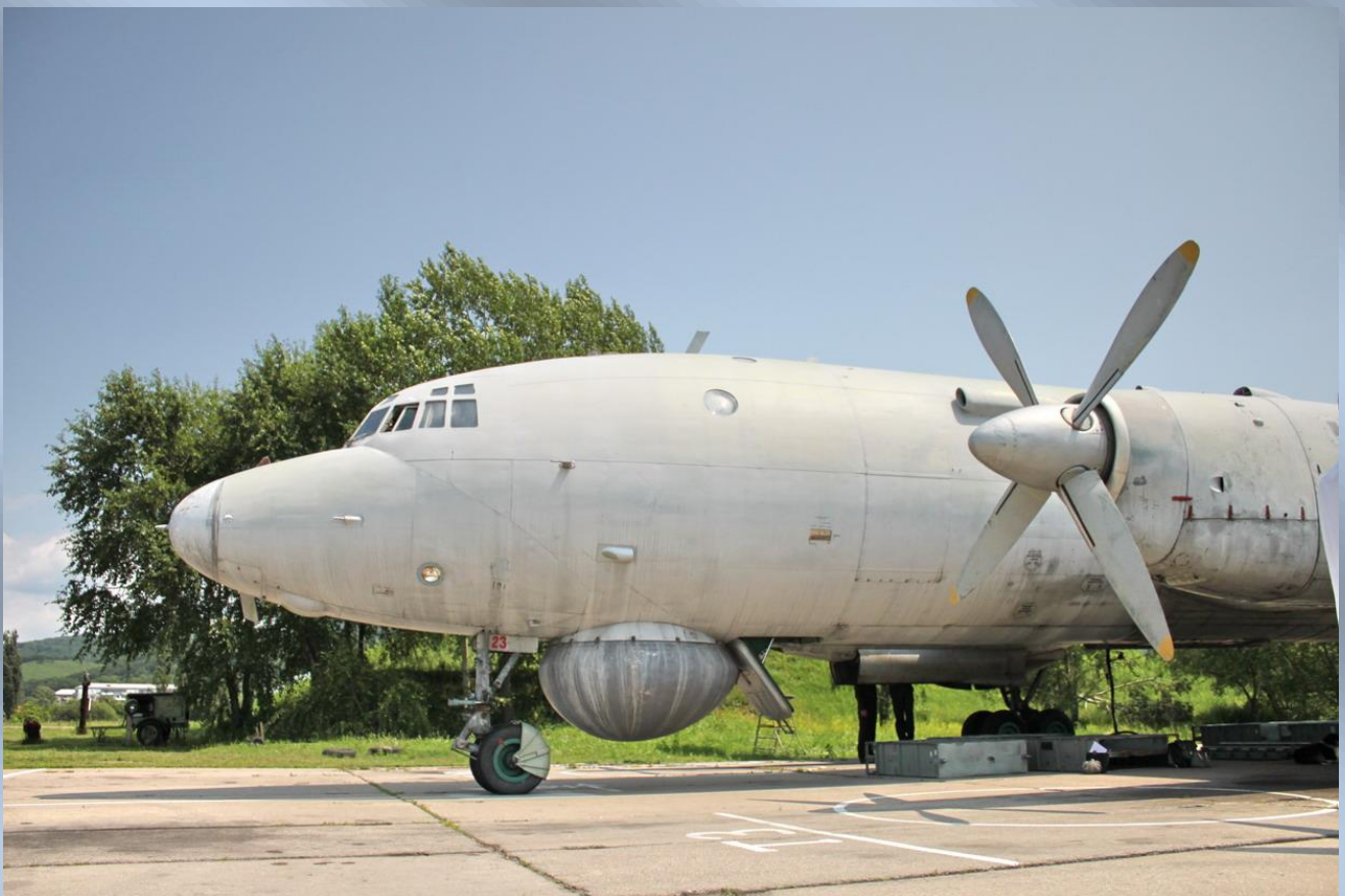
A légénységi bejárat átkerült a törzs oldaláról a lokátor-dóm mögé, amely így vészelhagyás esetén egyfajta szélfogó szerepet is betölthet
