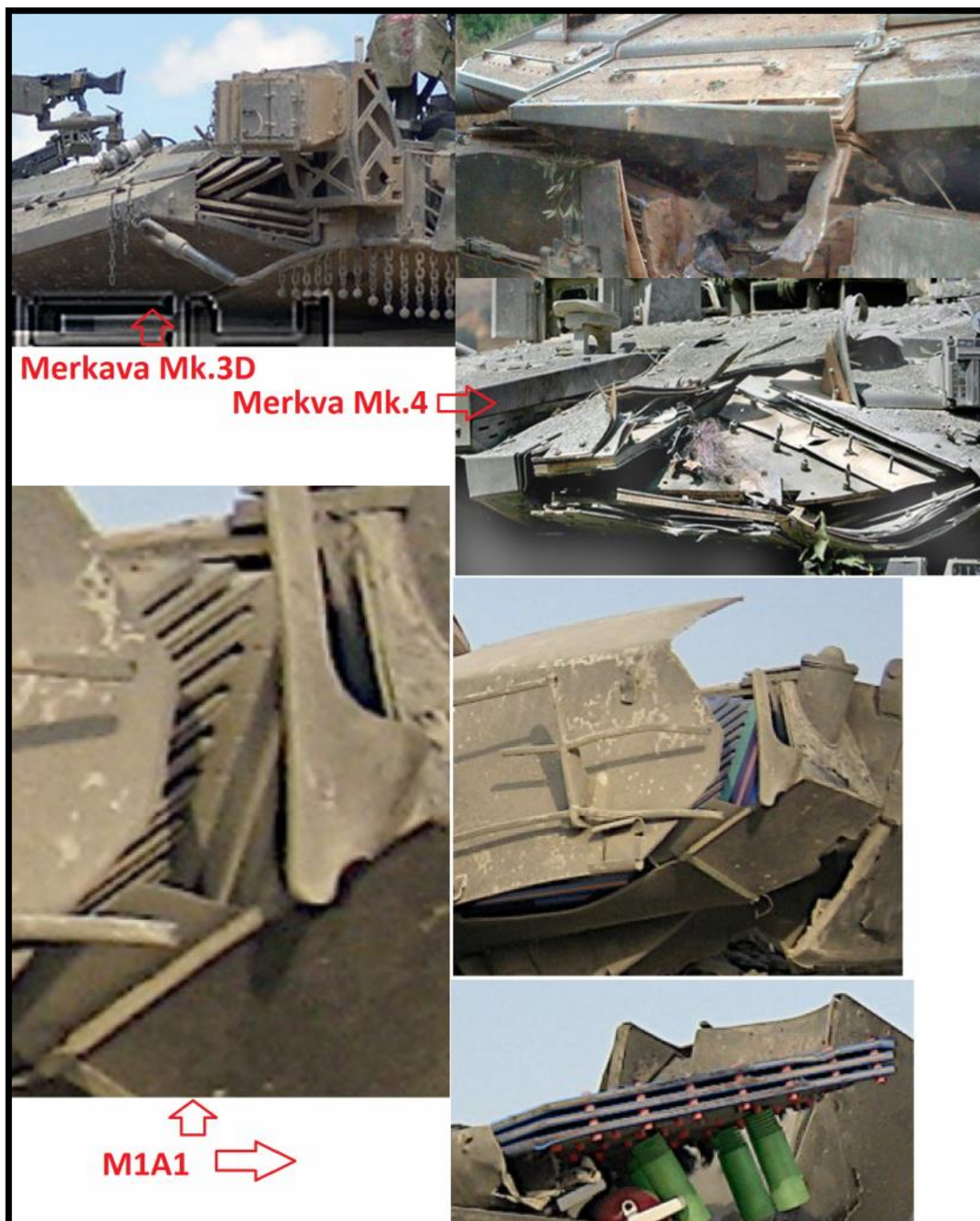
A képen a modern harckocsik NERA páncélzata
