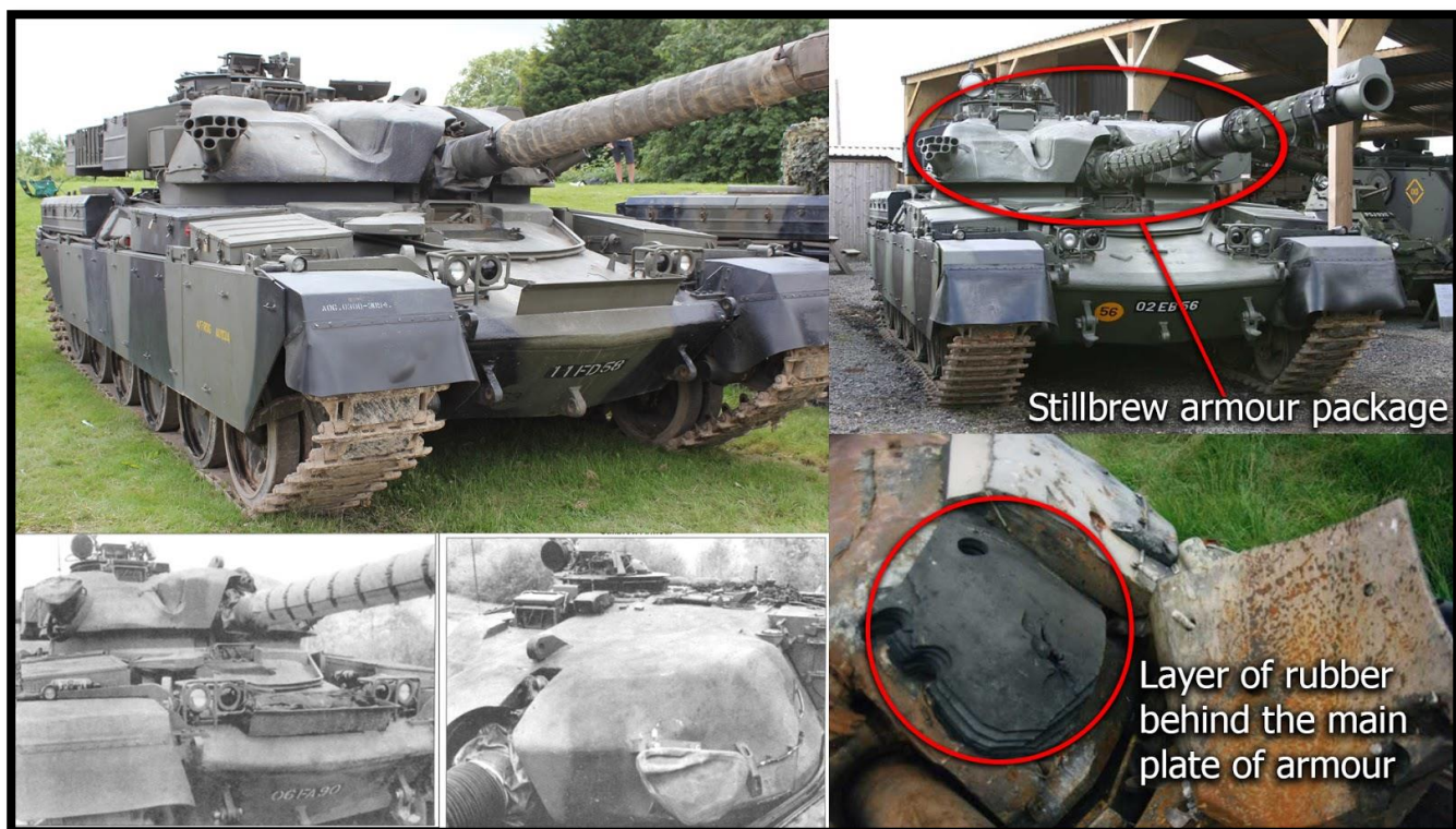
A képen a Chieftain harckocsi látható a nyolcvanas évek közepén felszerelt kiegészítő páncélzatával
