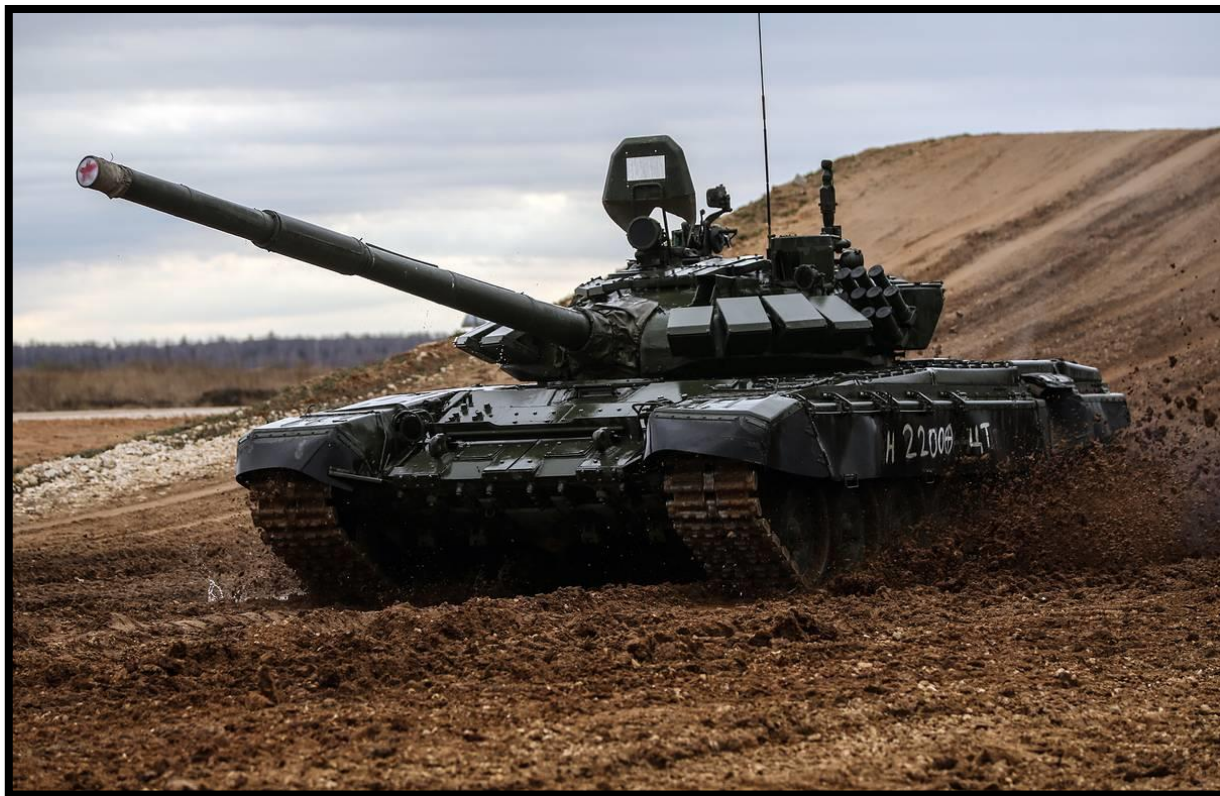
A fenti képen egy T-72B látható Kontakt-5 reaktív páncélzattal
