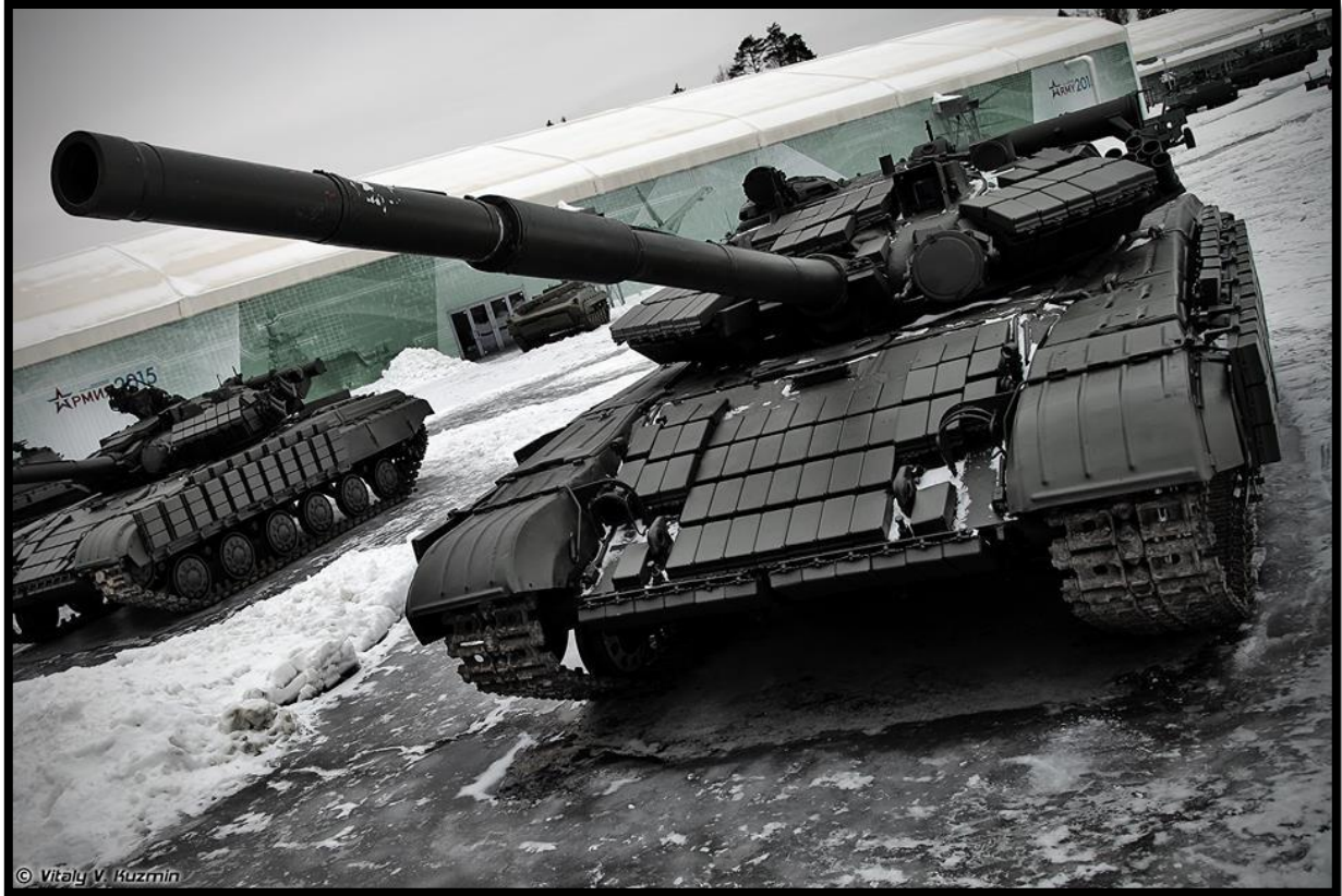
A fenti képen a T-64BV harckocsi látható, Kontakt-1 reaktív páncéllal felszerelve
