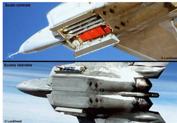
A fegyverzet belső elhelyezése: jól megfigyelhető a beszívók melletti fegyvertér (alsó kép)
