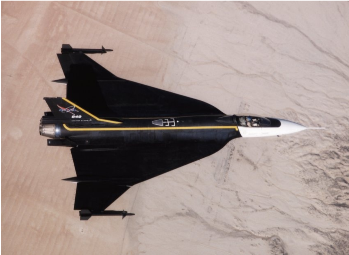
A határréteg-vizsgálatokra használt, passzív rendszerrel felszerelt gép
