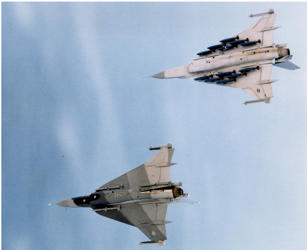
Az F-16XL géppár (a kétüléses gépen megfigyelhető az ellenfél megzavarására szolgáló festés)
