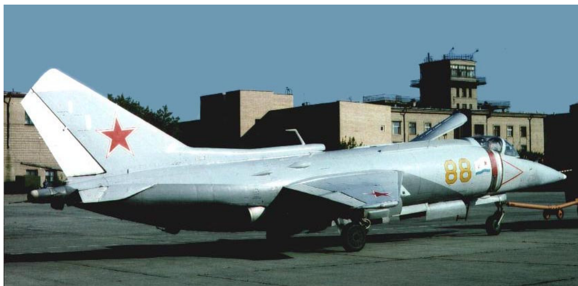
Jak-38-as késői világosabb színű festéssel. Az emelőhajtóművek beömlőnyílása nyitott helyzetben a kabin mögött.
