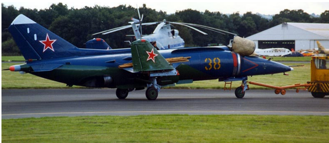
A Jak-38 szárnya a jobb tárolhatóság végett felhajthatóra tervezték. A főhajtóművek kiömlőnyílásai forgathatóak voltak.
