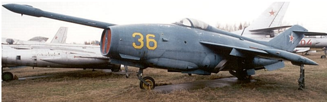
Az első szovjet helyből felszálló repülőgép a Jak-36-os. Jellegzetesen tömzsi alakot adtak neki a kabin alá ferdén beépített hajtóművek.
