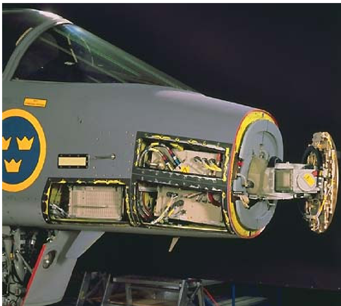
A vadászrepülőgép szeme, a PS-05 radar az orrban
