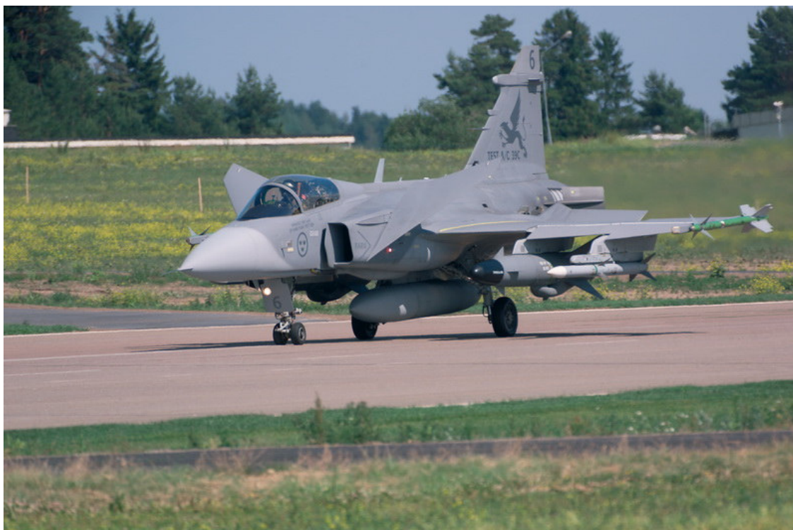
Leszállás után történő fékezésben szerepet kapnak a törzsféklapok, a felfelé mozduló elevonok a szárnyon és a kacsá elrendezésű vízszintes vezérsík is
