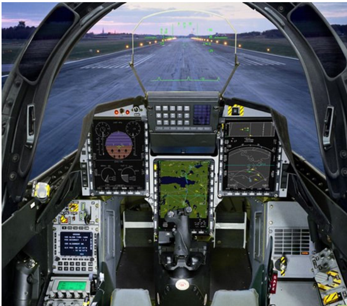
A pilótafülkét a kijelzők uralják. A joystick középre lett elhelyezve.
