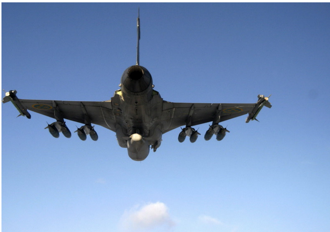
A kisebb bombák esetében ma már alkalmazhatóak a dupla függesztők.
