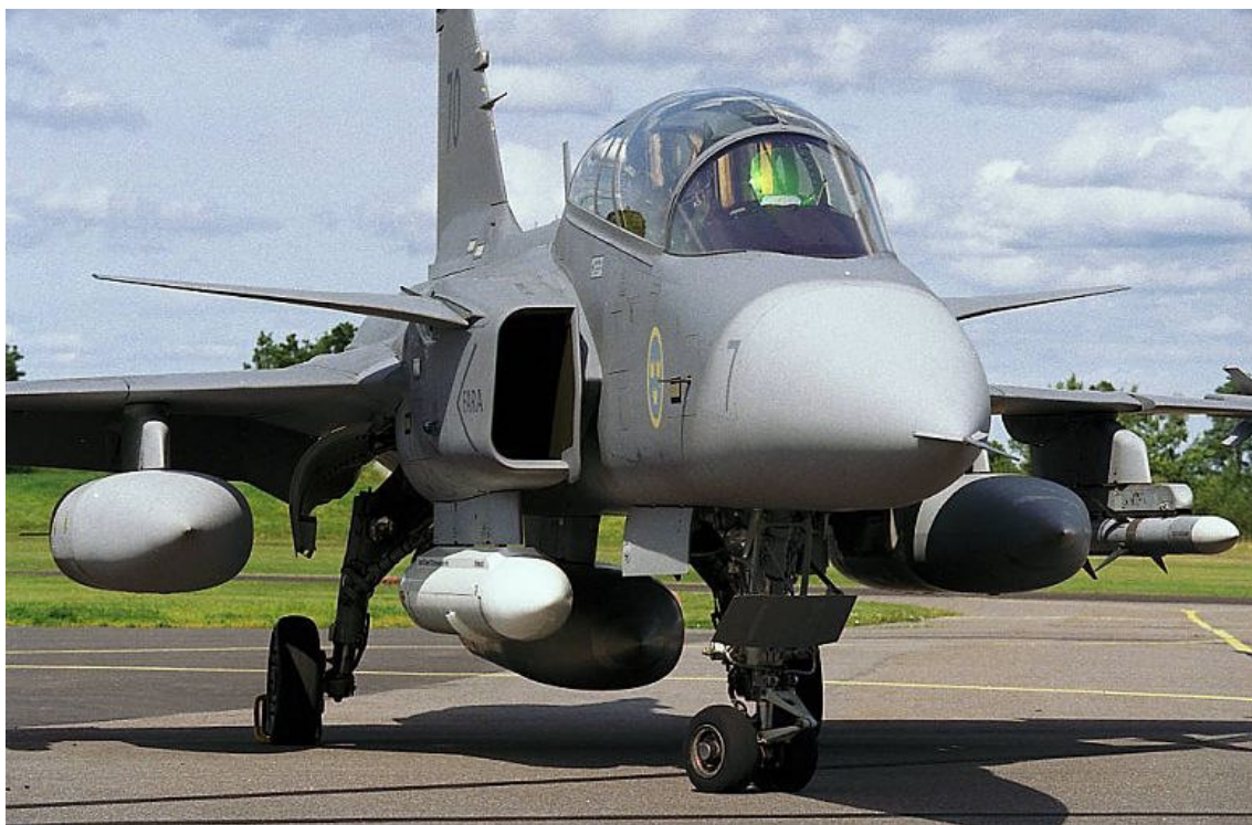
Felderítő konténer a jobb szívócsatorna alatt
