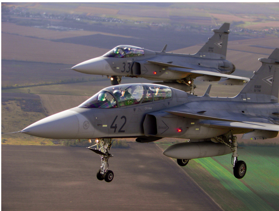
A robosztus futóművek a pontleszállások végrehajtását is lehetővé teszik
