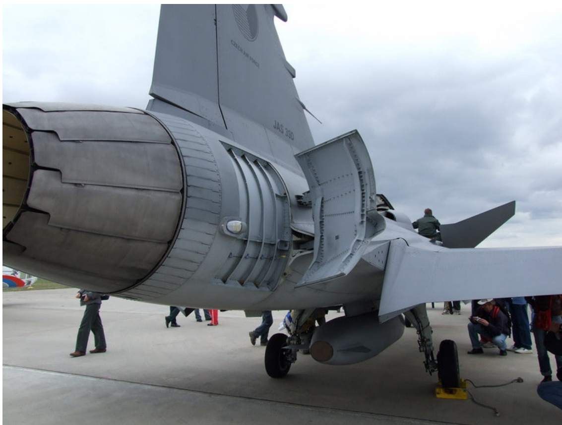
A törzs hátsó részén oldalt kialakított féklap nyitott állapotban (fotó: Block50)
