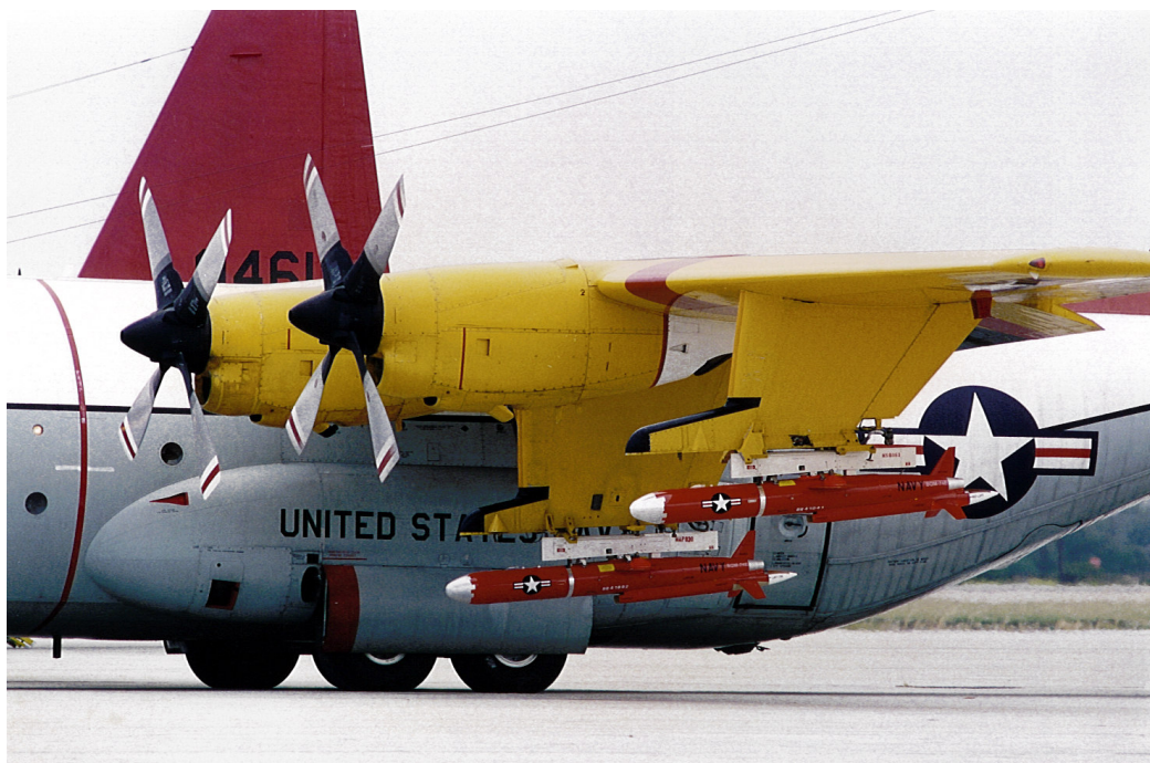
DC-130, szárnya alatt a drónok és függesztési pontjaik
