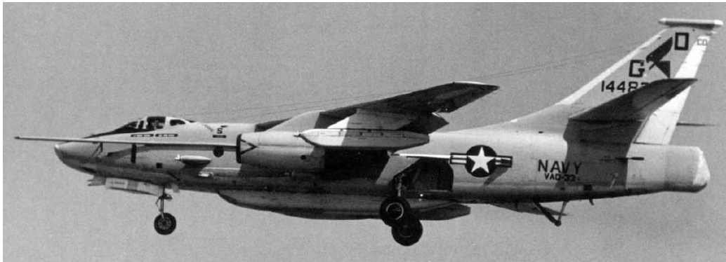
16. ábra. ERA-3B. Jól látszik a szárny alatt hordozott ECM pod, a RAT, valamint a törzs alatti hosszúkás kupola.
