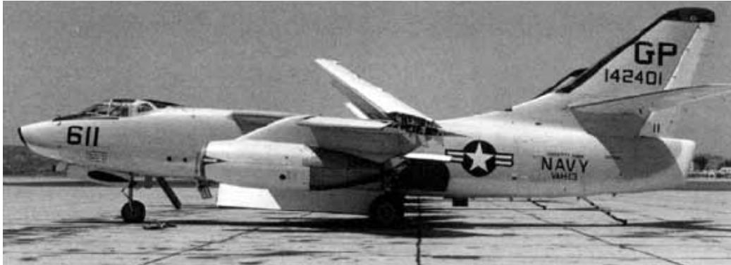
10. ábra. Flat Nose, dove tail. Itt már mindkét átalakítás megtörtént. Töltőcsónk még nincs.
