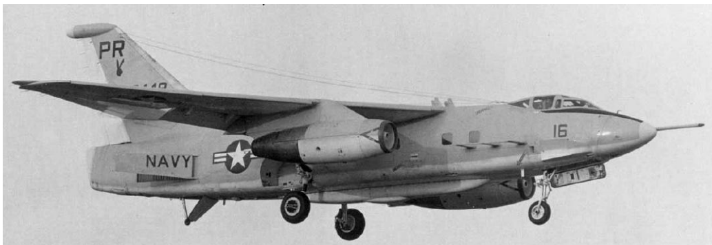
14. ábra. A3D-2Q/EA-3B 1974-ből. Jól látszanak az antennák a gép törzsén.
