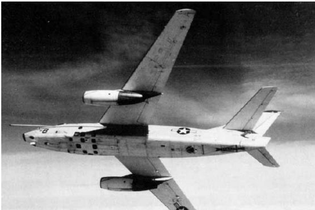
15. ábra. A gép alján jól láthatóak a kameráknak kialakított ablakok.
