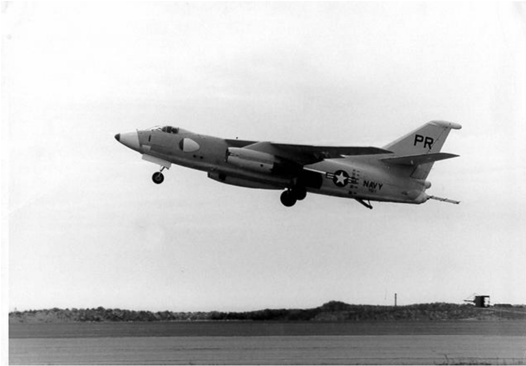
7. ábra. Jól látszik az ECM antennát rejtő kupola
