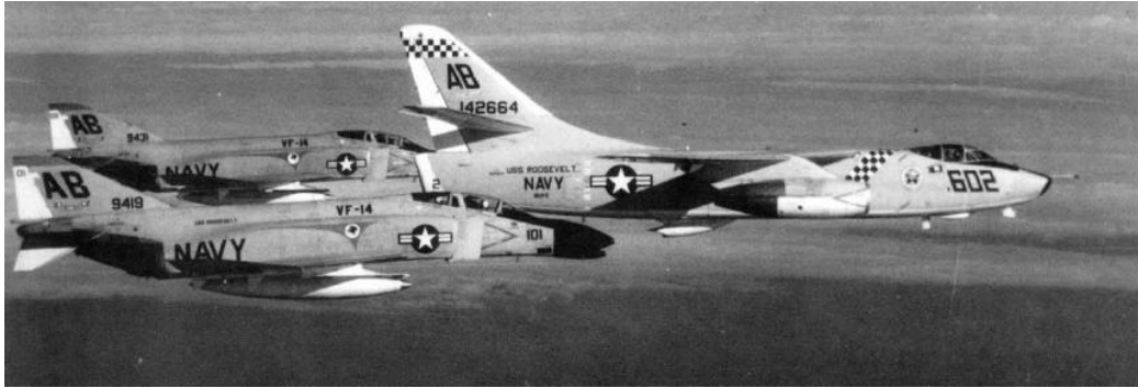
11. ábra. Tankercsomaggal felszerelt A-3B két F-4B Phantom kíséretében. A bombakamra helyén jól látszik a tankercsomag.
