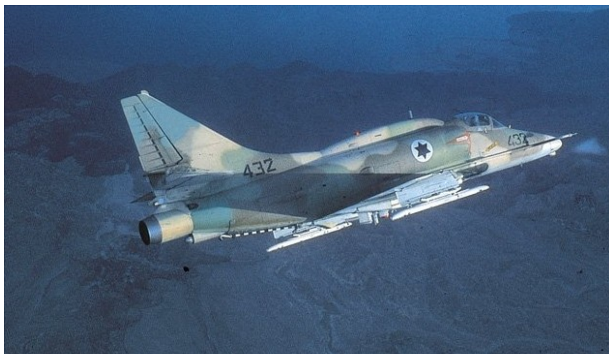
Izraeli Skyhawk. Jól látszik a hosszabb hajtómű kiömlő, amely az infravörös önirányítású rakéták elleni védelmet növeli.
