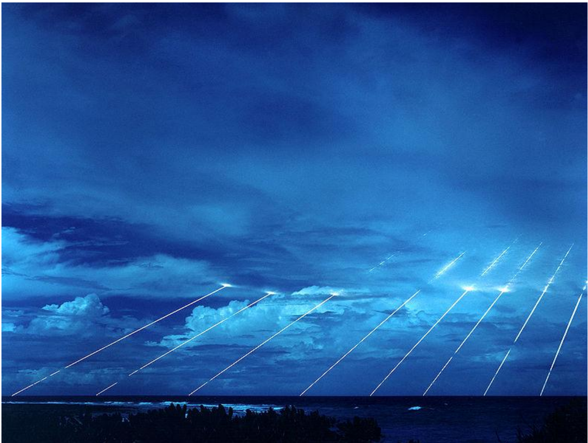
A Peacekeeper ICBM visszatérőegységeinek tesztelése (mind a 8 darabot egyetlen rakéta szállította)
