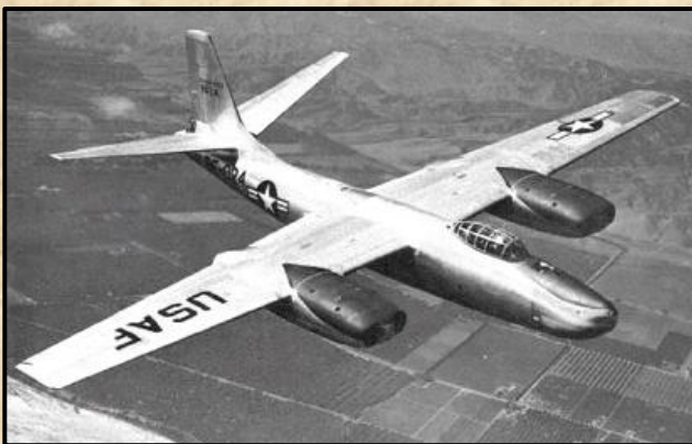
Balra a B-45 Tornado, jobbra az IL-28. Ezek az '40-es végén megjelent átmeneti bombázó gépek. A nagyobb sebességhez szükséges nyílazott szárnyú aerodinamikai kialakítás nélkül.
