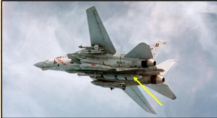
F-14 TARPS felderítő konténerrel. A konténer 5 méter hosszú és 840 kg tömegű volt. Nem véletlenül a hatalmas F-14 hordozta...
