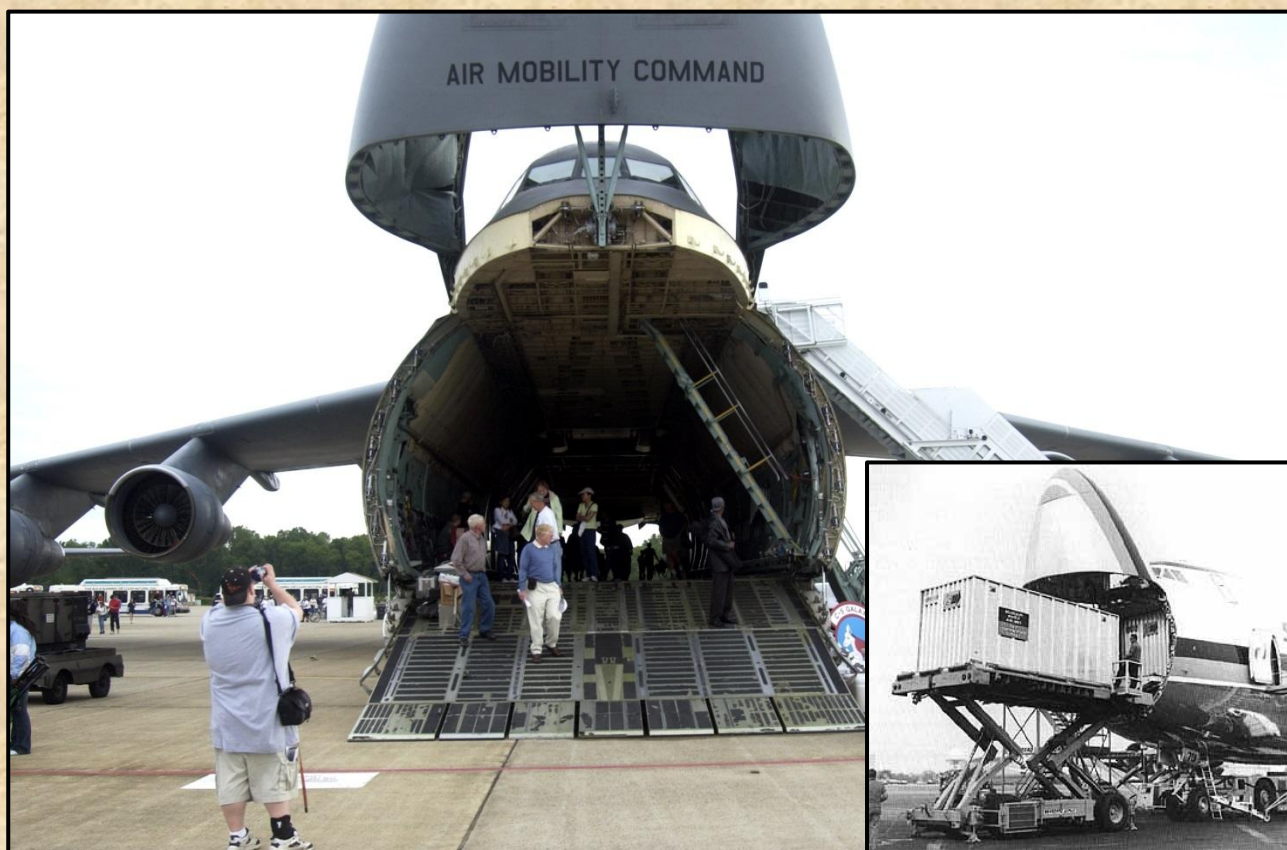
Egy C-5 Galaxy elöl és hátul is nyitott tehertér ajtókkal. Gyakorlatilag ahogy kirakodják az egyik oldalon már rakodható is a másikon vagy két irányban is lehetséges kirárolni. A tehertér méretei elég szemléletesek. A sarokban látható Boeing 747 hiába rendelkezik nyitható orra, nem képes azon jármű saját erőből behajtani és a tehertér keresztmetszete is kisebb.
