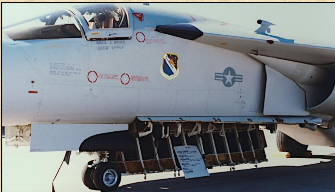
EF-111A Raven belső tere kinyitva, látszanak az elektronikai zavaró rendszer antennái.
