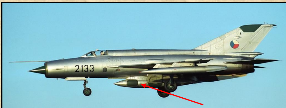
Csehszlovák MiG-21R balra, a törzs alatt felderítő konténerrel. Elég méretes...
