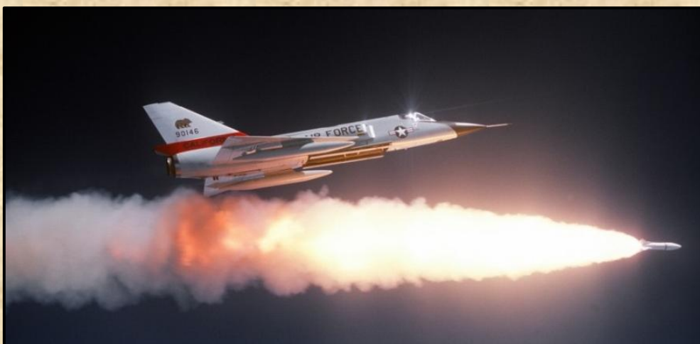
F-106 Delta Dart Genie rakétát indít. A típus különlegessége a belső fegyvertér volt, ami lehetővé tett nagy sebesség elérését. Az AIR-2 Genie légellenállása hatalmas lenne külső függesztés esetén.
