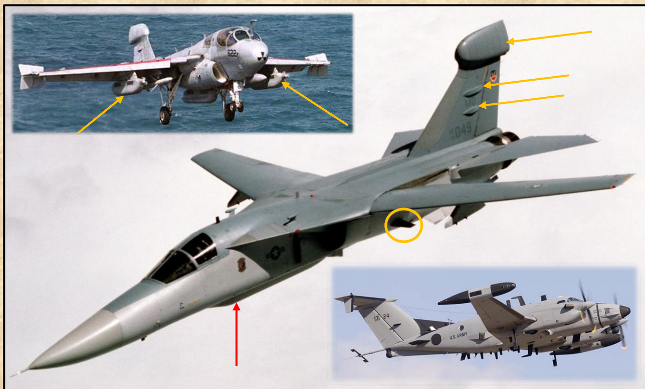
EF-111A Raven, A sárga nyilak és körök a plusz antennákat jelzik (nem az összezt), a piros nyíl a belső terébe helyezhető elektronikai hadviselésre szolgáló blokkot. A gép képességeiről árulkodik az, hogy a '80-as évek technikai szintjén az elektronikai zavaró rendszer tömege nagyjából 2700 kg volt. Az EF-111A konténer nélkül, az EA-6B Prowler (bal felső sarok) konténerekkel látja el a feladatát.
