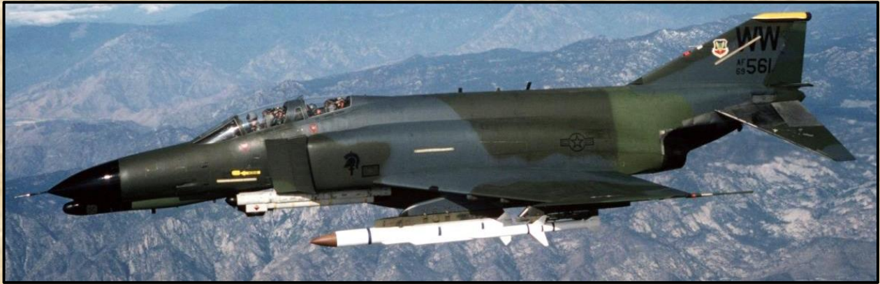
Egy F-4G Phantom II. Első pillantásra nem tér el az átlagos F-4 Phantom II-től, de az orr alatt levő érzékelők egyedi elhelyezése, a gépágyú hiánya és a szárnyak alatt hordozott fegyverzet igen könnyen felismerhetővé teszik. A képen egyébként ritkán látott fegyverzet függesztéssel látható, AGM-78 és AGM-45 rakétákkal.
