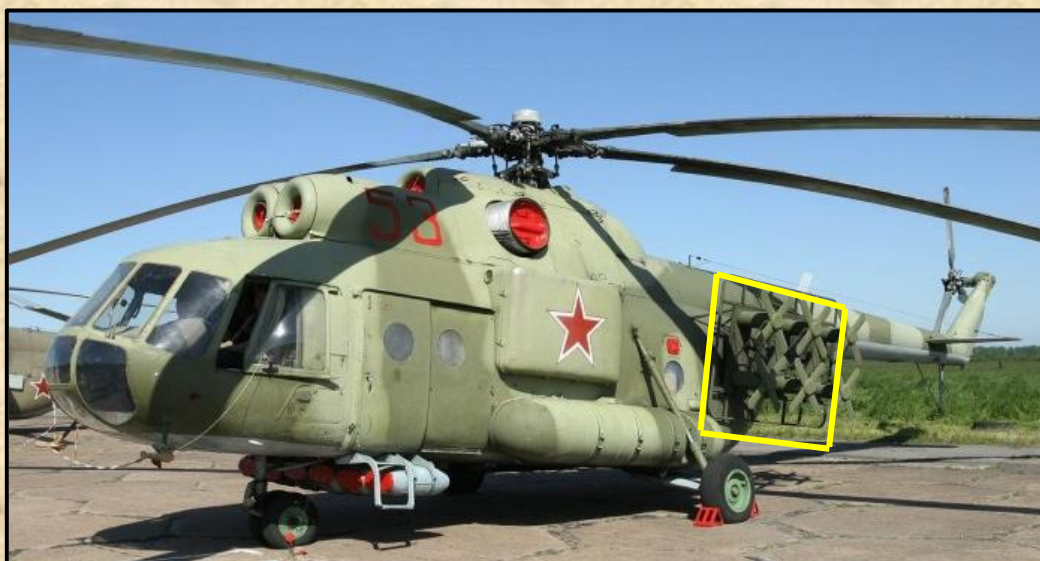
Mi-8 PPA. A helikopteren az „X” antennák nem szokványos kinézetűek.
