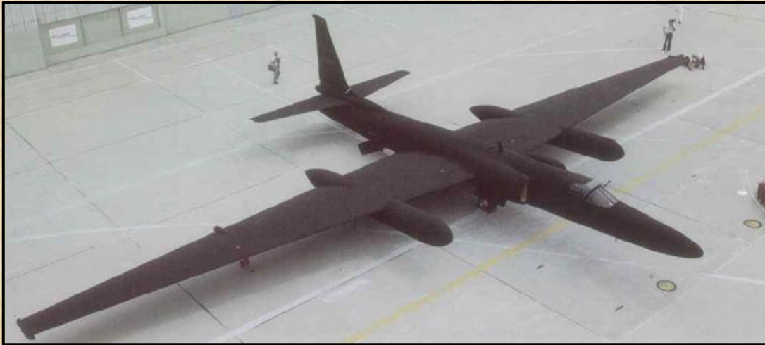
Az U-2 felderítőgép, bár sok szenzációhajhász írás csak kémrepülőnek titulálja. Tény, hogy végzett ilyen tevékenységet is, de nem csak ilyet. A gép méretei elég szemléletesek a mellette álló emberek jó viszonyítási alapot adnak.
