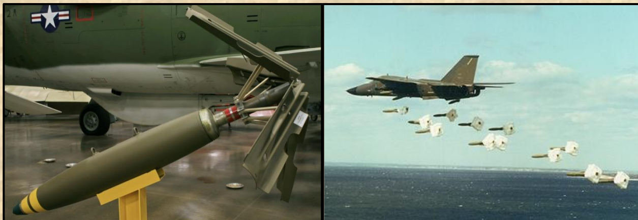
Baloldalt a kinyíló féklapos Mk-82 Snakeye, jobboldalt ernyővel fékezett BSU-49 bombák láthatóak
