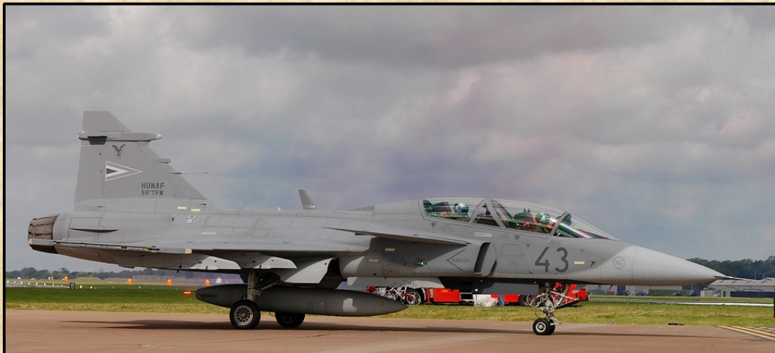
JAS-39 EBS HU Gripen függőleges vezérsíkján az a hosszúkás dudor rejtje az RWR rendszer egyik antennáját.
