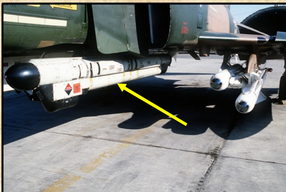
F-4E Phantom II ALQ-119 konténerrel jobb oldali törzsfelfüggesztési pont alatt, az egyik Sparrow rakéta helyén.
