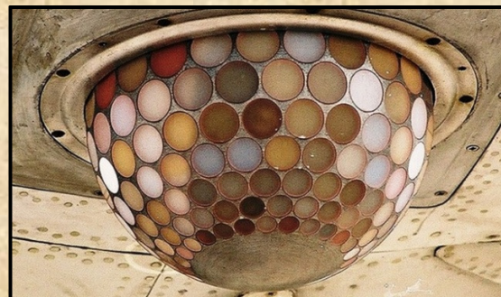
Su-24 MAWS érzékelője, jobb oldalt a Tu-95 egy változatán használt változat. A kettő szemmel láthatóan hasonló.
