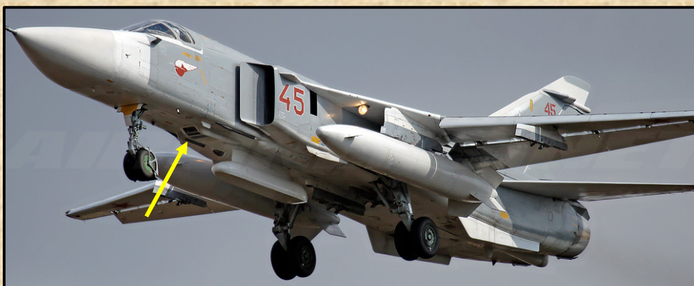
A Szu-24 orra alatt levő célmegjelölő és képalkotó helye. A fotó különlegessége a törzs alatt levő L-081 Fantazmagoria elektronikai konténer. A már említett AN/ASQ-213 konténerhez hasonló alkalmazás, SEAD feladatkört ellátó Szu-24 csapásmérők hordozhatják.
