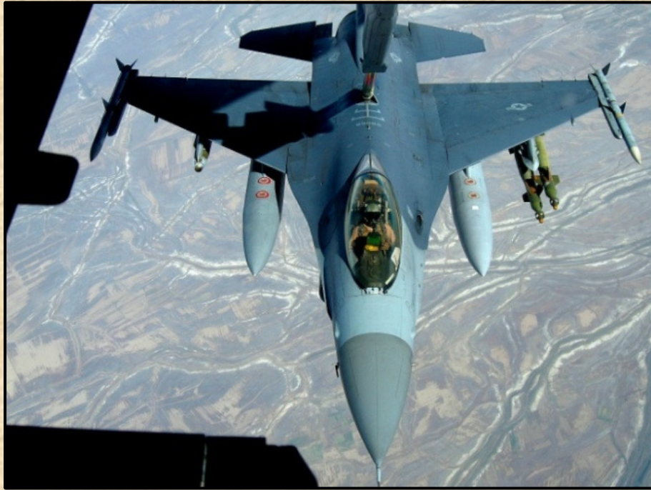
F-16C utántöltése merevcsöves rendszerrel. A felvétel az utántöltést végző személyzet operátor fülkéjéből készült.
