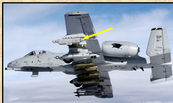
A-10A ALQ-131 konténerrel a bal külső szárnyfelfüggesztőn.
