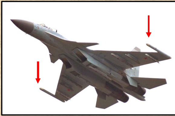
Valamilyen Szu-27 változat, szárnyvégi, valószínűleg Szorbcija típusú zavarókonténerekkel.
