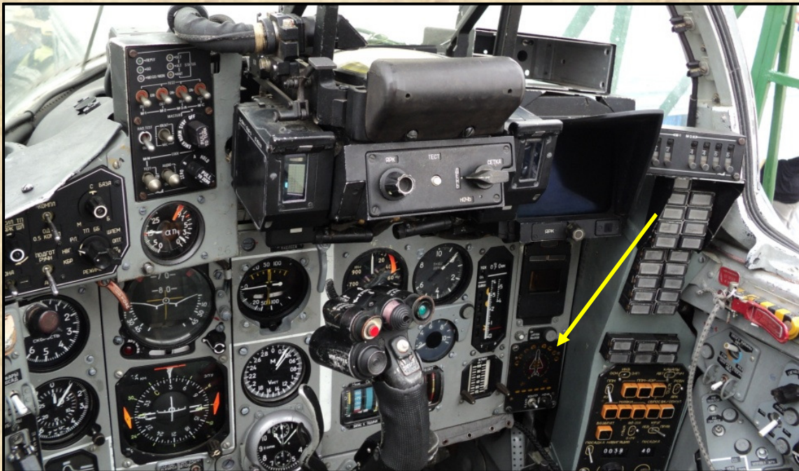
MiG-29 kabin, az elterjedt változatok ilyen kabin kialakítással bírnak. A besugárzásjelző jobb oldalt lent.
