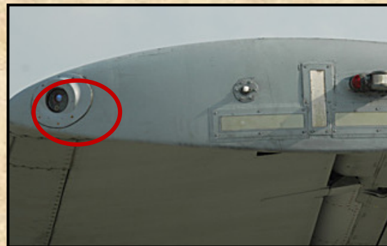
A körkörös figyelő rendszer elemei az A-10 Thunderbolt II gépen.
