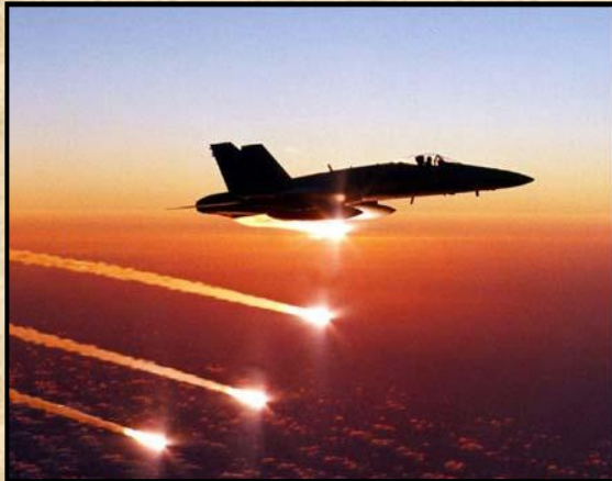
Infracsapda szórása F/A-18 repülőgépről és radarzavaró anyag töltetek.
