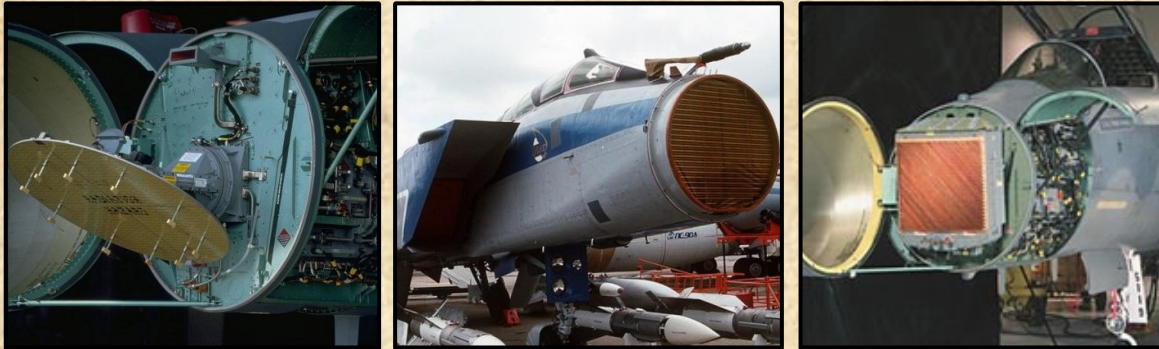
F-15E AN/APG-70, MIG-31 RP-31 Zaslon (Pajzs) és a F-15 AESA radarja balról jobbra.
