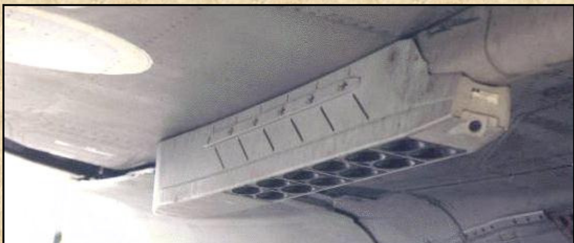
Kivető rendszer (dispenser), ez éppen egy JA-37 Viggen gépen
