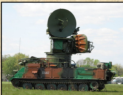
Kub (SA-6) mobil rendszer önjáró elemei, tűzvezető radar és indító jármű.
