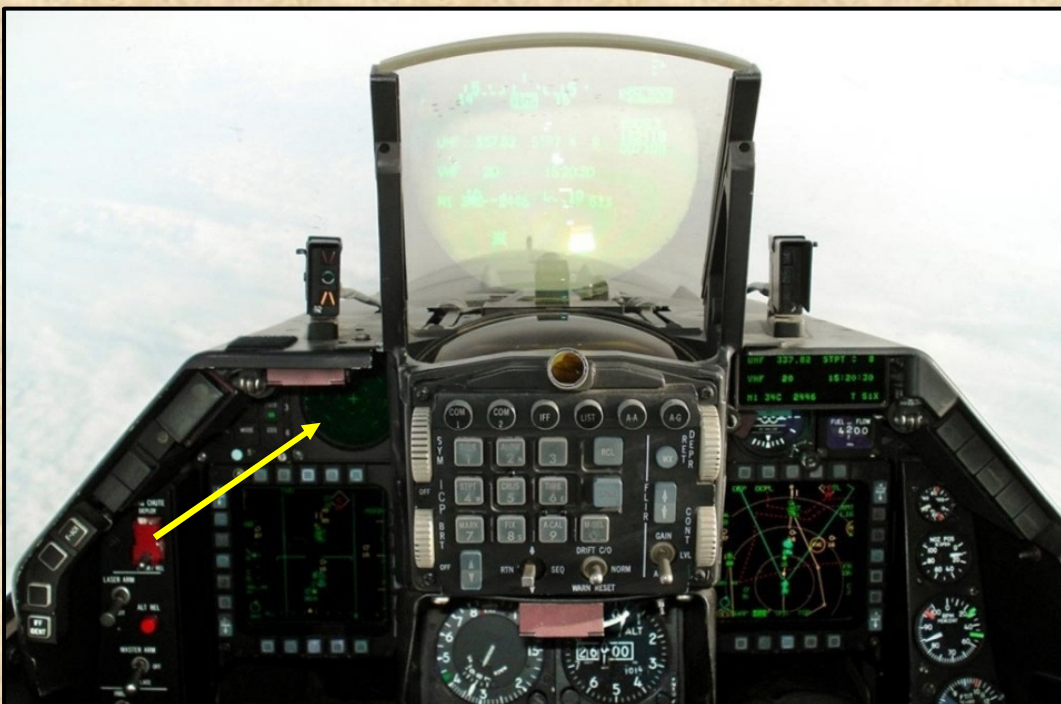
F-16C kabin, besugárzásjelző bal oldalt fent. (A többfunkciós kijelzők már színesek.)
