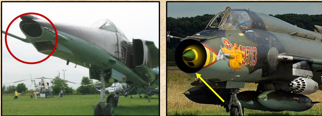
Bal oldalt valószínűleg egy MiG-27K , lézeres célmegjelölő és képalkotó rendszer üvegezésével. Jobb oldalt egy lengyel Szu-22 orrkúpjában látható lézeres célmegjelölő és céltáv mérő üvegezése.
