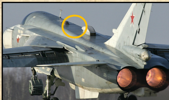
Su-24 MAWS érzékelője, jobb oldalt a Tu-95 egy változatán használt változat. A kettő szemmel láthatóan hasonló.
