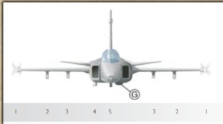
A JAS-39 C/D gépek felfüggesztési pontjai.
