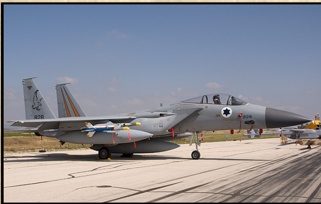
Baloldalt az IAF F-15C vadásza, jobboldalt az USAF egy keflaviki USAF F-15C-je. Mindkettő oldalán jól látszanak a szívócsatorna oldalára felszerelt illeszkedő tartályok.
