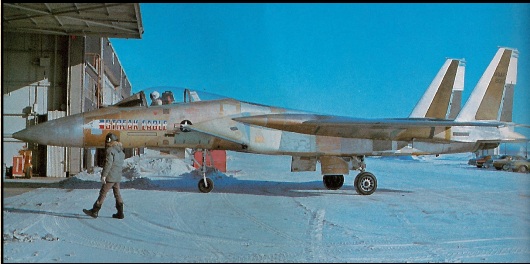
Streak Eagle a földön. A fotó a 15 km, vagy a feletti rekorddöntési kísérlet után készült. A pilóta nem a szokványos öltözékben, hanem a nagy magasságú repüléshez biztonsági okokból használt túlnyomásos szkafanderben foglalt helyet a gép pilótafülkéjében.
