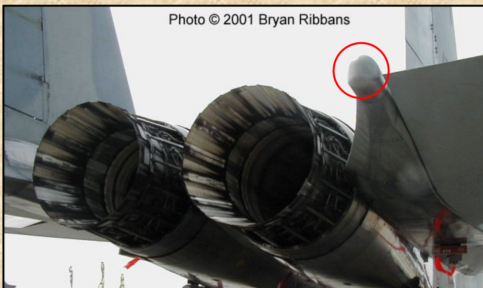
Az ALQ-135B hátrafelé néző ECM antennája 1995 után.
