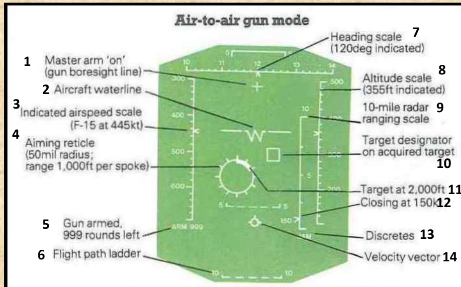
A HUD levegő-levegő üzemmódban, gépágyús célzóüzemmód.
