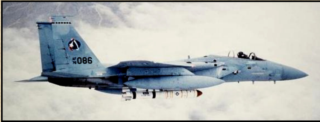
Egy ASM-135A ASAT (Anti SATellit) rakéta egy F-15A törzs alatti függesztési pontján.
