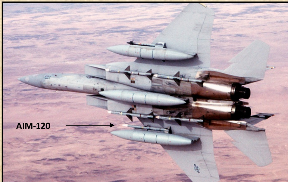
F-15C a Sivatagi Vihar hadművelet vége felé vagy közvetlenül utána, a repüléstilalmi övezet fenntartásakor. A hordozott fegyverzet vegyes, átmeneti korszakot tükröz. A törzs felfüggesztési pontokon AIM-7M, a szárnyak alatt azonban már 1-1 darab AIM-120A AMRAAM és 1-1 darab AIM-9M Sidewinder van a gépre szerelve.
