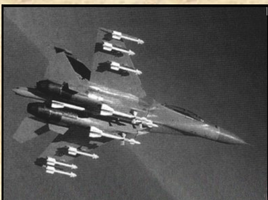
Egy kétüléses Szu-27 vagy Szu-30 teljes légiharc fegyverzettel. hordozhat. Hasonlóan az F-15-höz négy darab kis hatótávolságú infravörös vezérlésű (R-73) és négy darab látótávolságon túli célok elleni rakétát (R-27), legalábbis ez a legésszerűbb konfiguráció.
