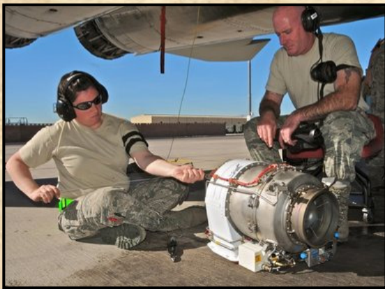
A JSF egység, az hajtóműindító kisméretű gázturbina.
