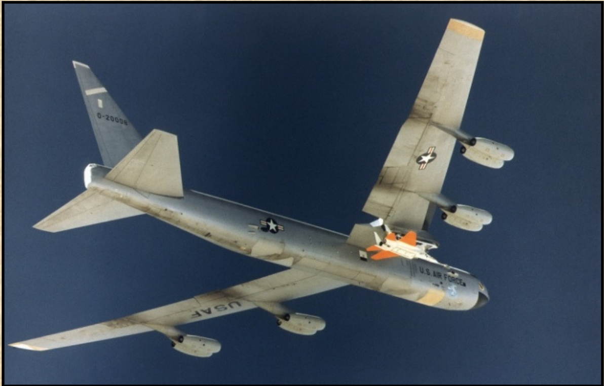
Az egyik RPRV modell a B-52 anyagép szárnya alatt.
