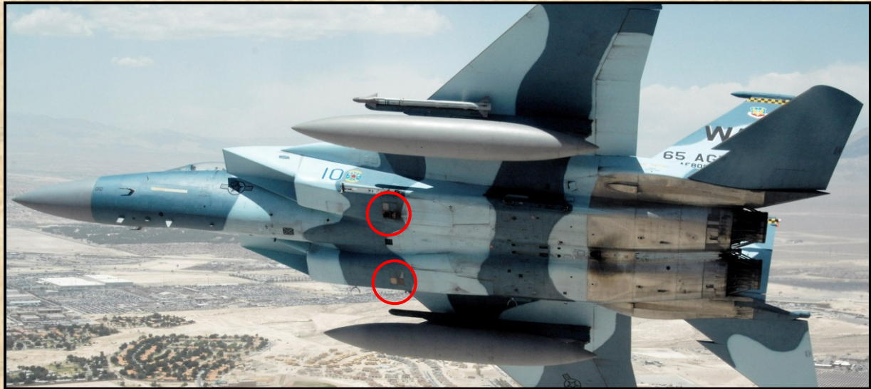
Egy „agresszor” F-15C, részben letakart vagy belemezelt zavarótöltet kazettákkal.
