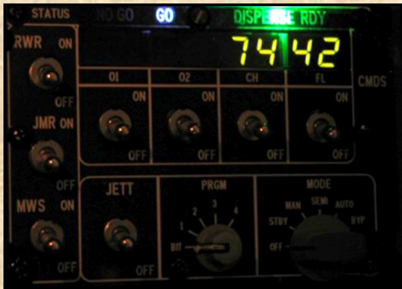
Az F-16C/D gépek EWS panelja a '80-as és '90-es években, de mai napig repülnek gépek ilyen konfigurációval.
