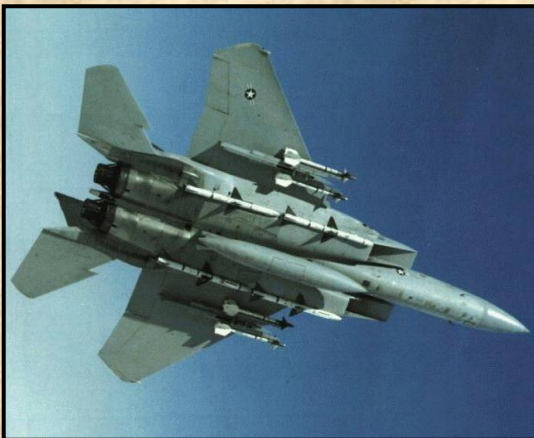
Egy Sas teljes légiharc fegyverzettel, póttartályt csak a törzs alatt függesztési ponton hordoz.
