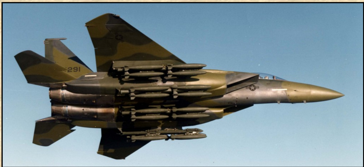
F-15E demonstrátor alaposan megpakolva. A csapásmérő fegyverzet hordozására is alkalmas illeszkedő tartályokkal repül a gép.
