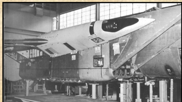
A GAU-7 mockup 41 beépítve a géptörzsbe.
