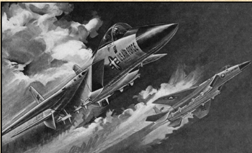
Koncepció rajz az egyik McDonnell Douglas változatról. Merevszárnyú a konstrukció, hat légiharcrakétát hordozott volna. Két AIM-7 és négy AIM-82-öt. A gép formailag nagyjából a NASA módosításai előtti F-15 koncepciót tükrözi, 1969 végi-1970 eleji állapot.
