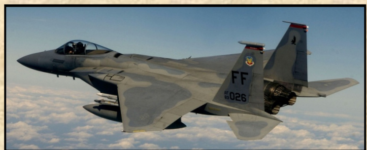
Fent: Az egyik első példány még az eredeti stabilizátor és szárnyvégi kialakítással.
