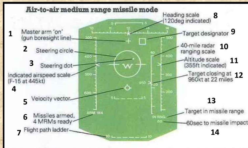
A HUD levegő-levegő, közepes hatótávolságú légiharckrétá esetén használt üzemmód.
