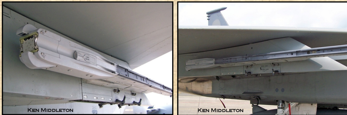
BOL sínek az F-15C szárnygerendájának oldalán, a rakéta-indítósín végén.
