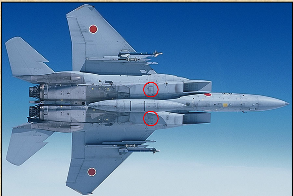
Japán F-15J belemezelt zavarótöltet-kazettákkal.
