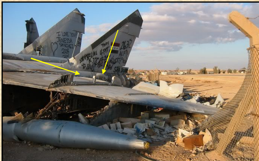
Egy MiG-25 roncsa sok évvel a Sivatagi Vihar után. A szárny felső részén látható a KDSz-155 zavarótölteteket tartalmazó kazetták helye.
