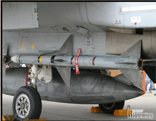
AIM-7 felfüggesztése a Sason, a rakéta vezérsíkjai a törzshöz simulnak. (F-4K). A gépágyú maximális javadalmazása 940 lövedék.
