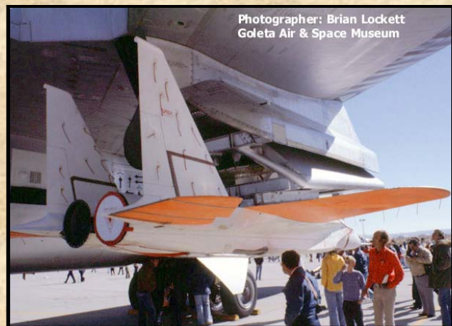
Az RPRV földet érés előtt nyitott csúszó talpakkal (NASA archívum) és a B-52 jobb oldali szárnya alá függesztve.
