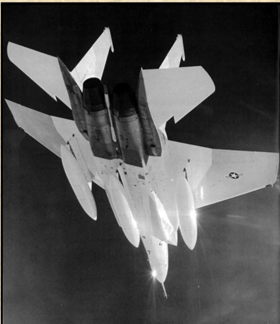
Az egyik átmeneti kialakítással bíró gép, a vezérsík már farkasfog kialakítású, de szárnyvég még nem ferde.
