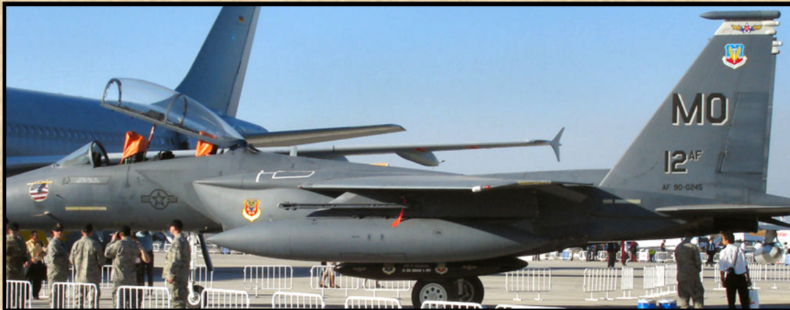
Egy F-15E oldalnézetben. Látható a szárny belépőél íveltségének és a szárny profilvastagságának változása.
