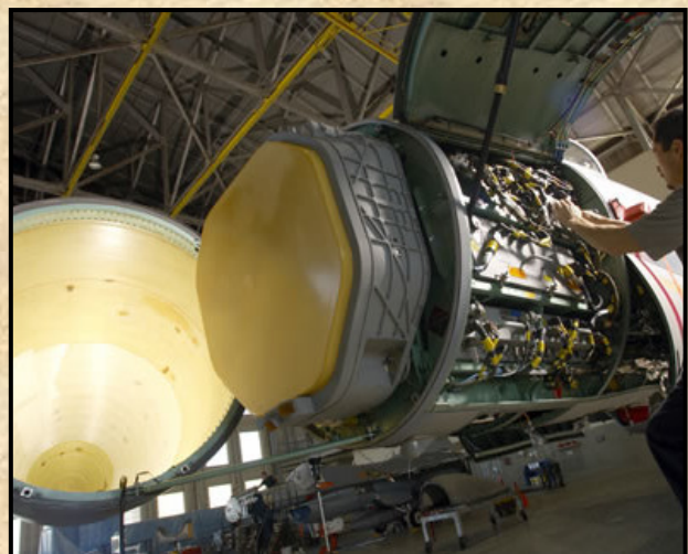
Baloldalt az AN/APG-63(V)2, jobboldalt a (V)3 változat látható.
