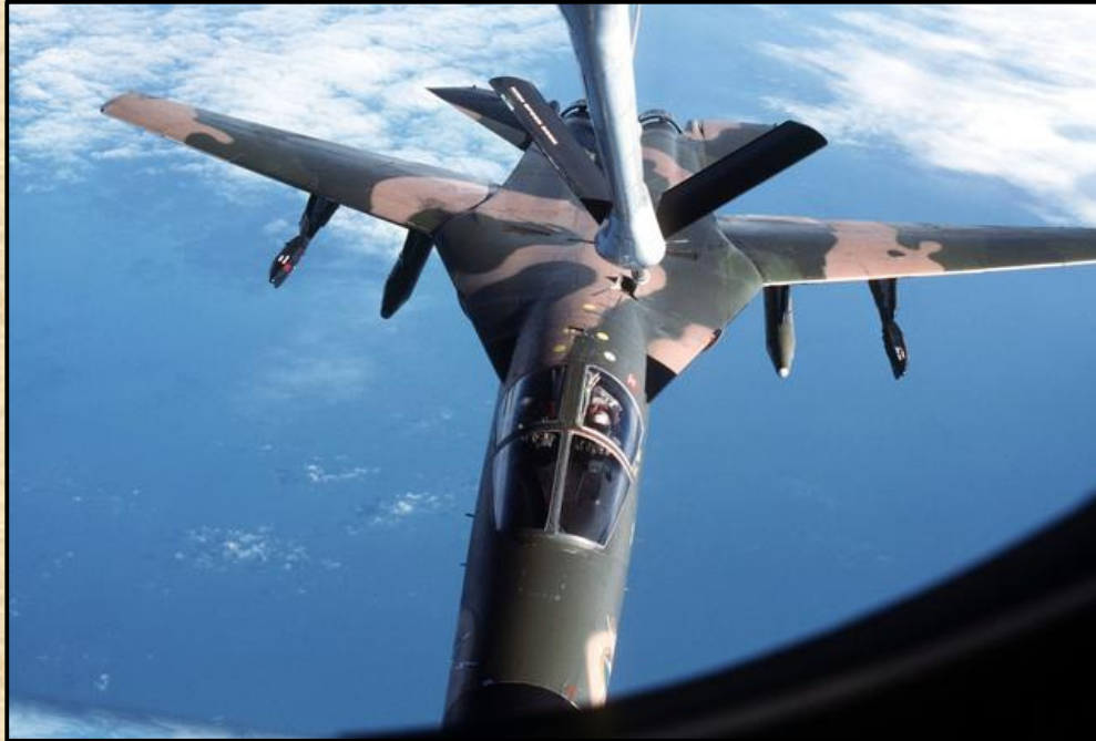
Légítankoló nyílása a kabin mögött volt, a légierőben használt merevcsöves rendszerrel lehetett utántölteni a gépet.
