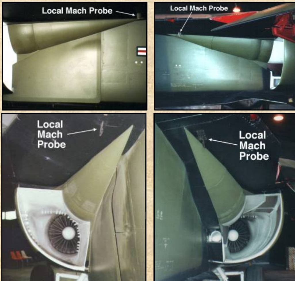
Szemből látható a beömlő előtti borítólemezek eltérése. A hajtómű beömlőnyílás és a törzs között a távolság megnőtt, ahogy a „tüske” (kúp) hosszának eltérése is jól látszik.
