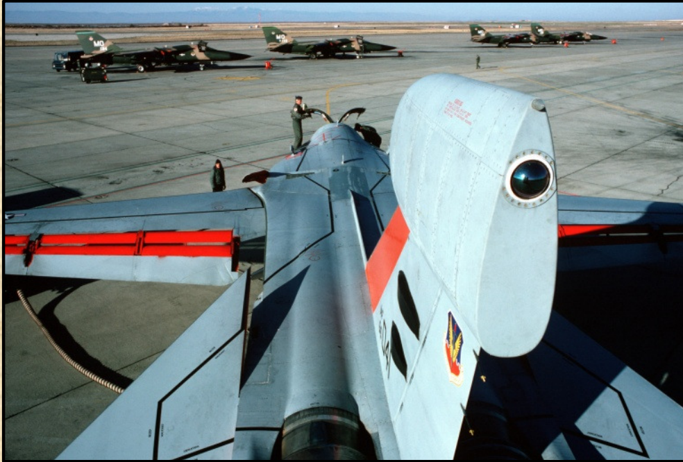
Az Raven függőleges vezérsíkjába épített infravörös rendszer kamerájának nyílása és átlátszó burkolata.
