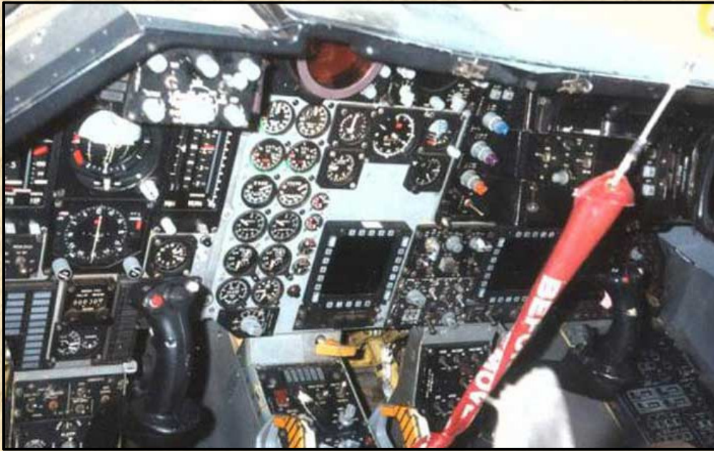
F-111F kabin, az AMP modernizáció után. Jól látható a két MFD. 107
