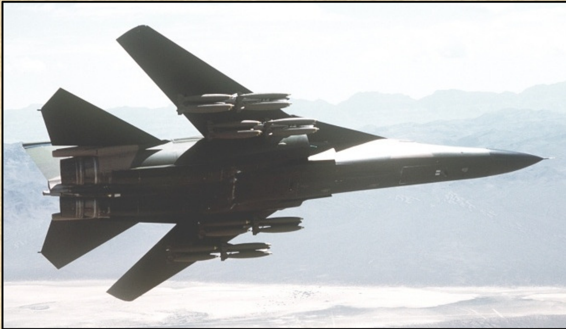
Egy ritka pillanat, a gépen négy darab többzárás tartó van, a tartókon „slant four” konfiguráció szerint vannak a bombák felpakolva.
