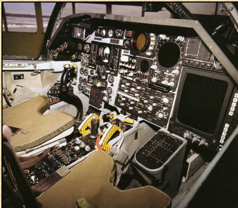
Az új pilótafülke. A pilóta oldali rész továbbra sem túl ergonomikus, de azért van már némi változás és javulás. Az operátor oldalon akkori szemmel nézve tekintélyes méretű kijelző és kulturált kezelőpult volt.
