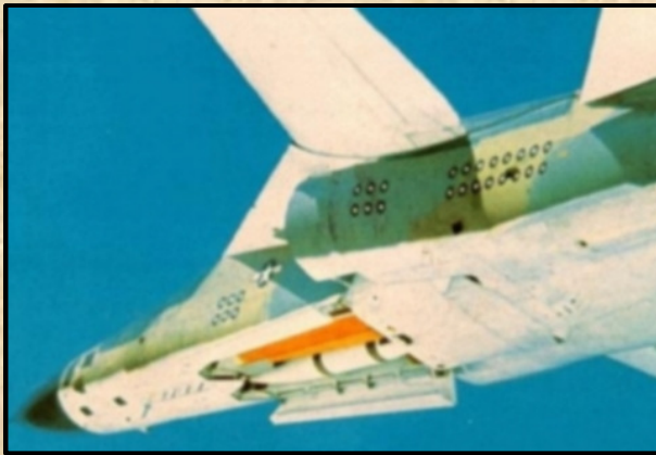
FB-111A gépek belső terében „Tokyo” 53 póttartály és nukleáris fegyverzet.
