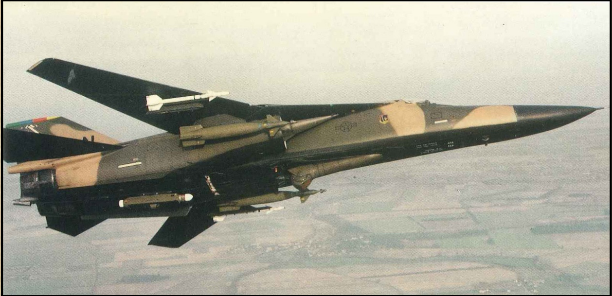
Klasszikus „lézerbombázó” felfüggesztési konfiguráció egy F-111F gépen. Két Paveway II GBU-10 bomba kiforgatott Pave Tack rendszer, ALQ-131 zavarókonténer és, két AIM-9P Sidewinder a 3A/6A helyen
