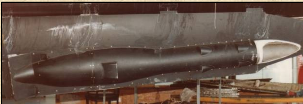
Oldalnézetből a lent látható modul. A gép alja felől így néz ki, ha ki van hajtva az ajtó. Jobbra a gépágyú torkolata, a hátul levő nyíláson távozik a lőporgáz.
