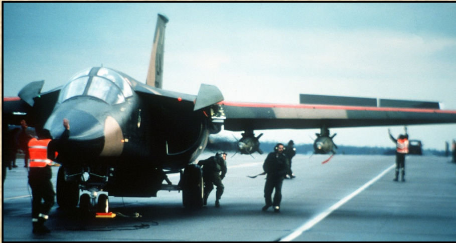
Spoilerek nyitott állapotban a szárnyon. A kép érdekessége, hogy az El Dorado Canyon hadműveletre való felkészülés látható rajta. Minimális 16 fokos szárnybeállításnál a fix belépőél elején egy áramvonalas mozgó szekció kinyílik, mert csak így fér el a szárny.
