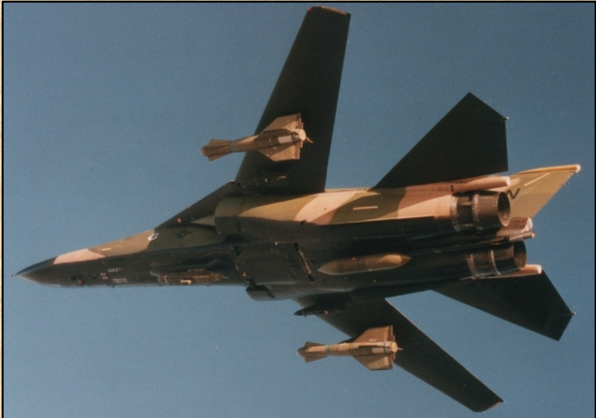
A szárnyak alatt két darab GBU-15 siklóbomba. A törzs hátsó felfüggesztés pontján az AXQ-14 adatátviteli rendszer konténer, az ALQ-131 elektronikai zavaró konténer a belső fegyvertér alatt a 493th FS F-111F gépén valamikor a '80-as évek közepén. A gép hasán, a zavarókonténer mögött a négyzetes rész a főfutóaknákat rejtő ajtó, ami egyben törzsféklapként is funkcionált.
