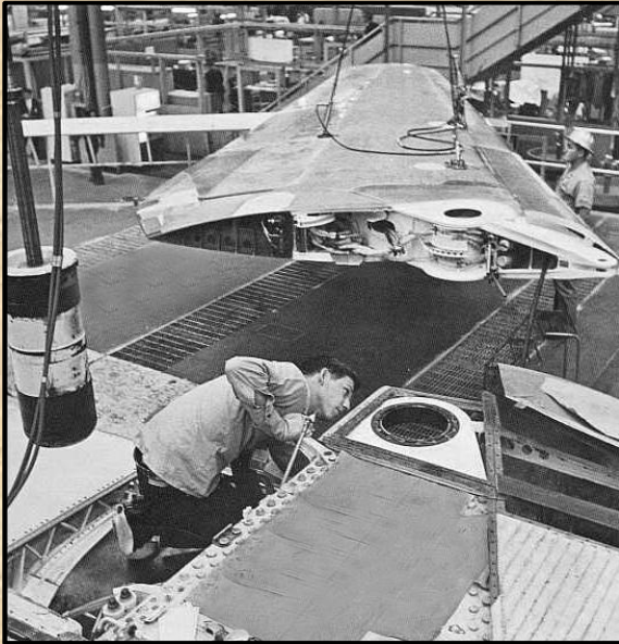
Az F-111 gyártás közben, a szárny felszerelése előtt. Jól látható a főtartó (csap), ami körül elfordul a szárny és változtatható a szárny nyílazása.
