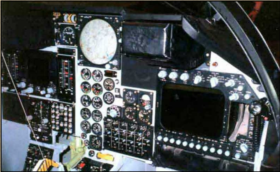
F-111D pilótafülke. Baloldalt a VSD jobboldalt a nagyobb MSD kijelző. A kezelőszervek elrendezése kezd egy egészen újfajta koncepciót megvalósítani, ami csak 15-20 évvel később érik be igazán.
