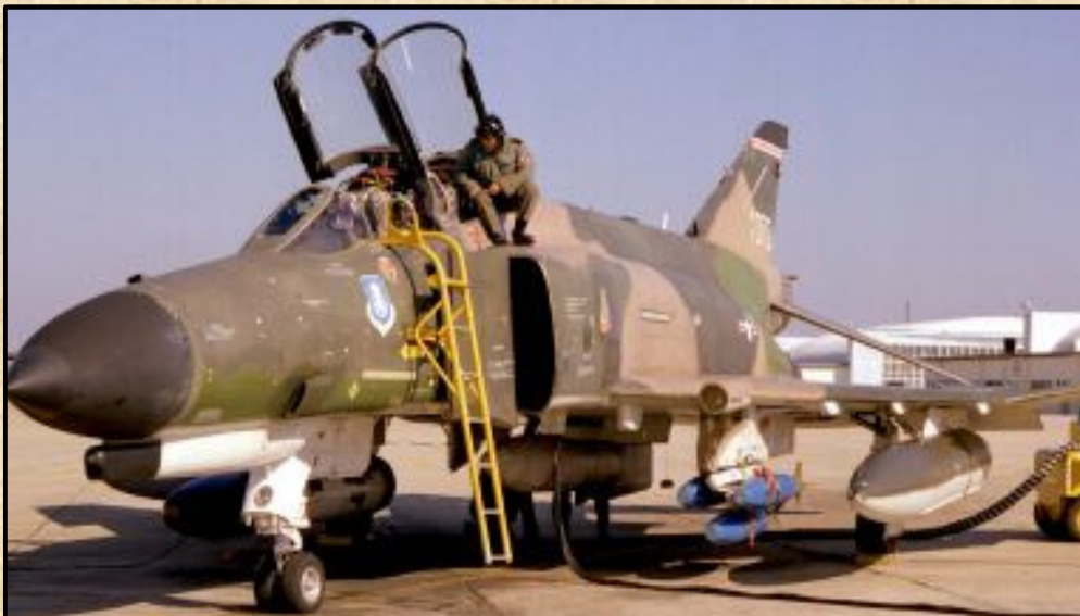
F-4E törzse alatt az AVQ-26. (A bal szárnyon levő optikai szenzor egyértelműen utal az altípusra.)
