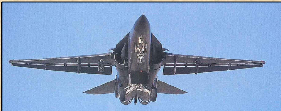
A gép leszállási konfigurációban. Törzsféklap részlegesen nyitva, mert a futókat csak így lehet kiengedve tartani. A szárny 16 fokos nyilazási szögbe állítva, a többszörösen részelt fékszárnyak kibocsájtva.
